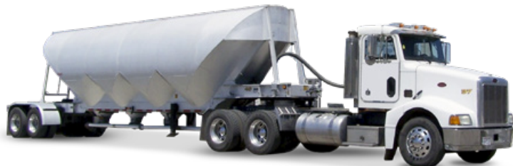
Granel en camión de tolva presurizada (Bulk in pressurized hopper truck)
